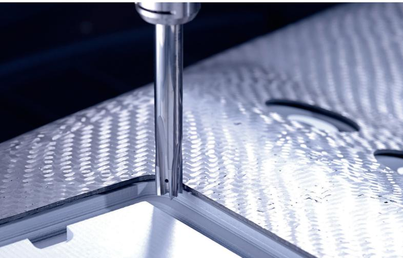
**1** Diamantbeschichtete Werkzeuge bewähren sich auf ganz verschiedenen Anwendungsfeldern, zum Beispiel wie hier beim Zerspanen von faserverstärktem Kunststoff, aber auch von Grafit im Werkzeug- und Formenbau oder von Aluminium
